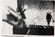
EL ESPEJO DE RETROVISION pegado con epoxy al parabrisas, rompe el vidrio cuando se trata de desprenderlo. Los fabricantes de automóviles esperan poder usar la substancia hasta para adherir el cromo a la carrocería.
