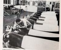
LOS CUBOS DE LAS HELICES tienen franjas de Tellon plástico, resistente a la fricción, adheridas con epoxy entre ciertas partes movibles. La resistencia del Tellon a la fricción resulta de que casi nada se le pega, salvo el epoxy.
