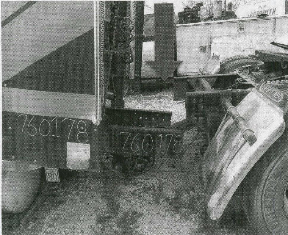
Figura 4. Foto de después, vehículo destruido (con rieles del bastidor cortados)
