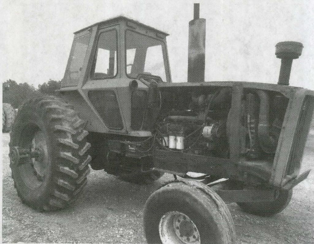
Figura 8. Foto de antes, con rieles del bastidor sin cortar
