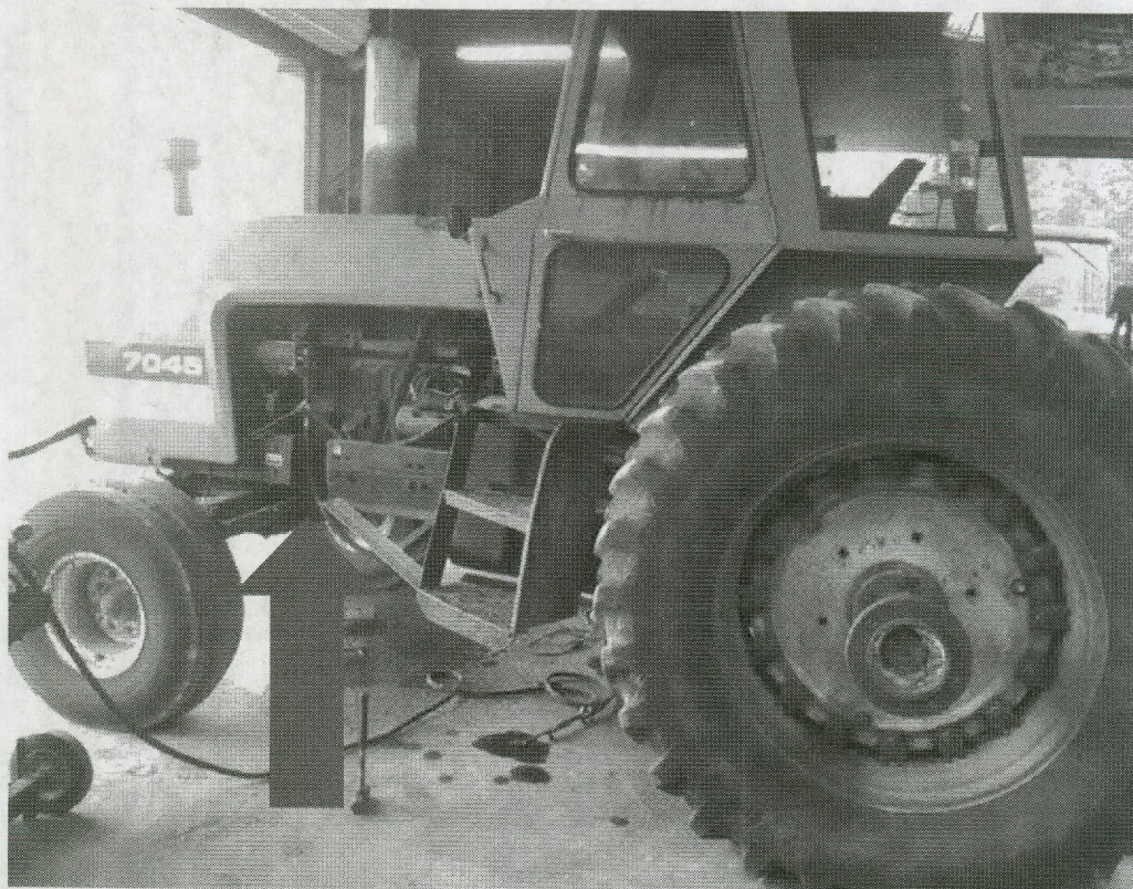
Figura 9. Foto de después, equipo destruido (con rieles del bastidor cortados)
