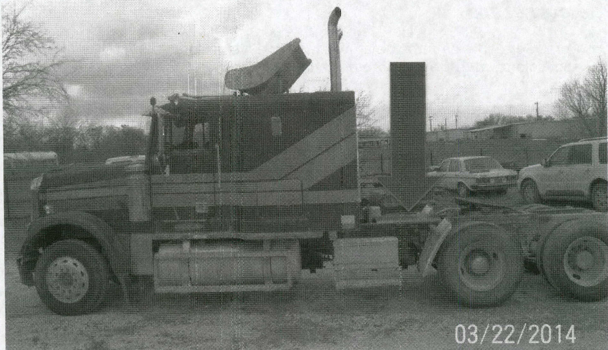
Figura 3. Foto de antes, con rieles del bastidor sin cortar
